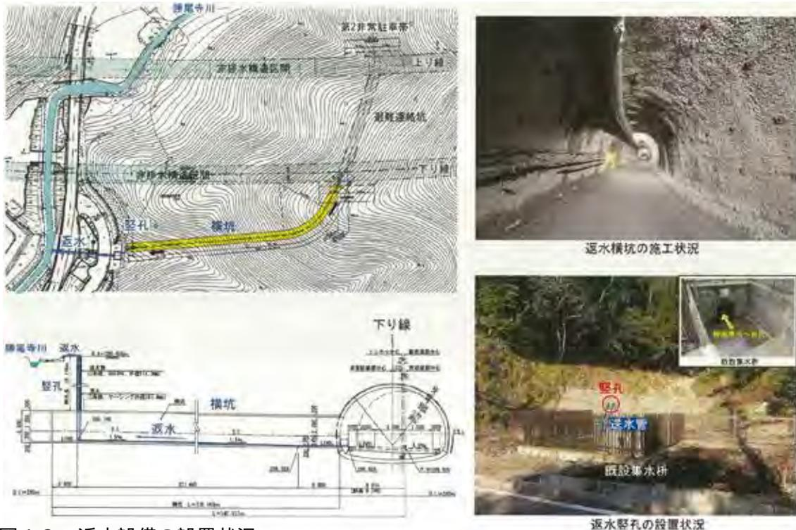
図12 - 返水設備の設置状況
